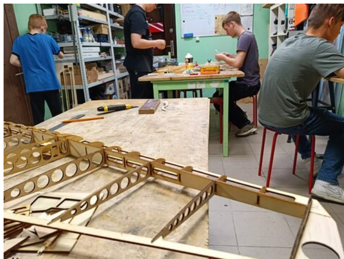
Работа в мастерской на ул. Заполярная, сборка моделей воздушного боя нарезанной на станке лазерной резки
