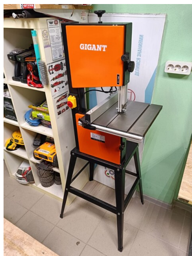
Пила ленточная для распиловки досок на рейки различного сечения
